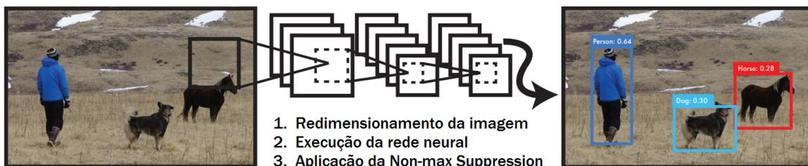
Figura 11 – Estrutura do algoritmo YOLO
