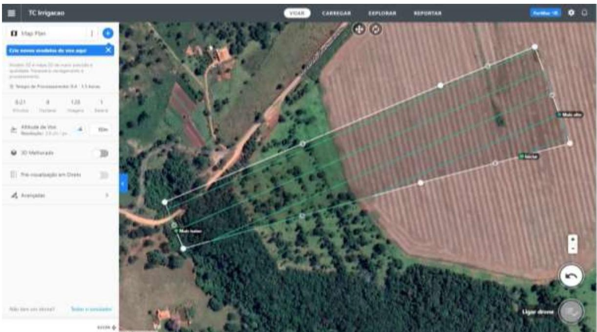
Figura 9. Coleta de dados de desnível para dimensionamento de pivô central através do uso do drone na área do Instituto Federal Goiano, 2023.
