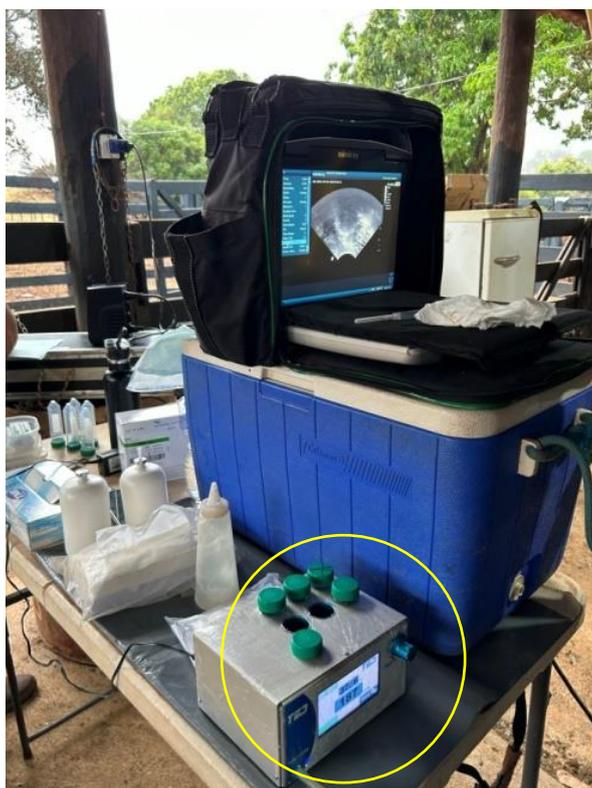
Figura 1 - Mesa para OPU. Círculo amarelo: bomba a vácuo.
