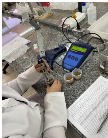
Figura 24: Leitura do pH do solo em água no pHmetro.
