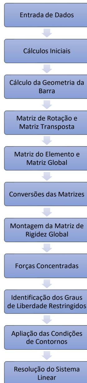
Figura 11: Processo de Cálculo de Pórtico 3D
