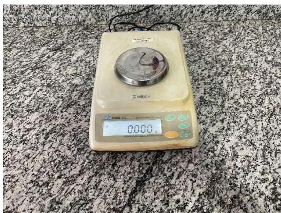
*Figura 9 Balança de precisão GEHAKA BK 600 utilizada na pesagem das amostras de 100 grãos*
