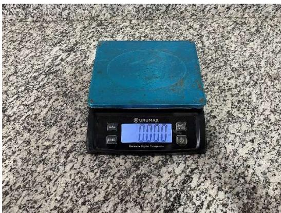
*Figura 8 Balança utilizada para a pesagem das amostras logo após serem trilhadas*
