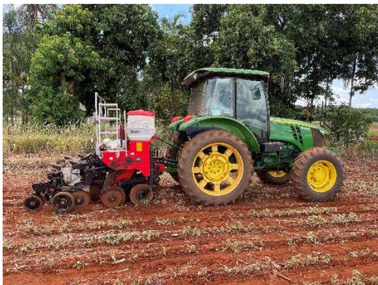
Figura 3 Semeadora e trator visão Lateral.
