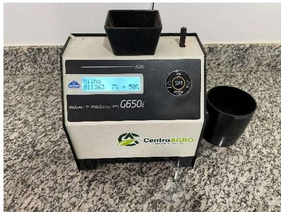
Figura 10 Medidor de umidade GEHAKA G650i
