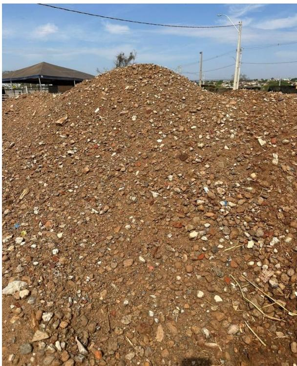
**Figura 2:** BGS proveniente de RCD.
