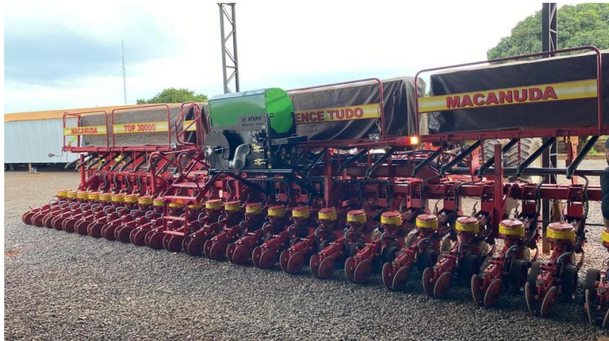
Figura 3: Máquina da Mamp montada em uma plantadeira da Vende Tudo de 30 linhas na região de Quirinópolis - GO.
