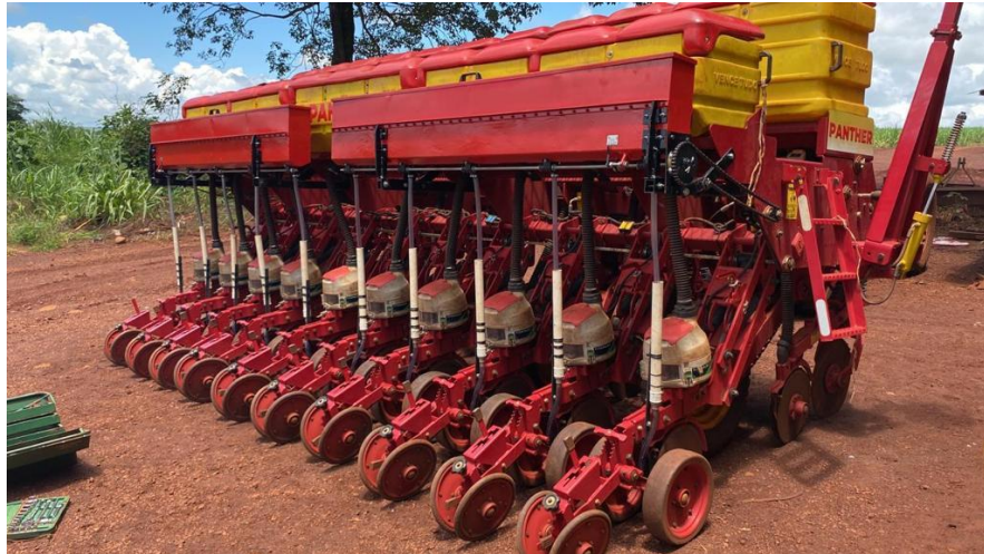
Figura 5: Máquina da Morgenstern montada em uma plantadeira da Vence Tudo de 10 linhas na região de Quirinópolis – GO.
