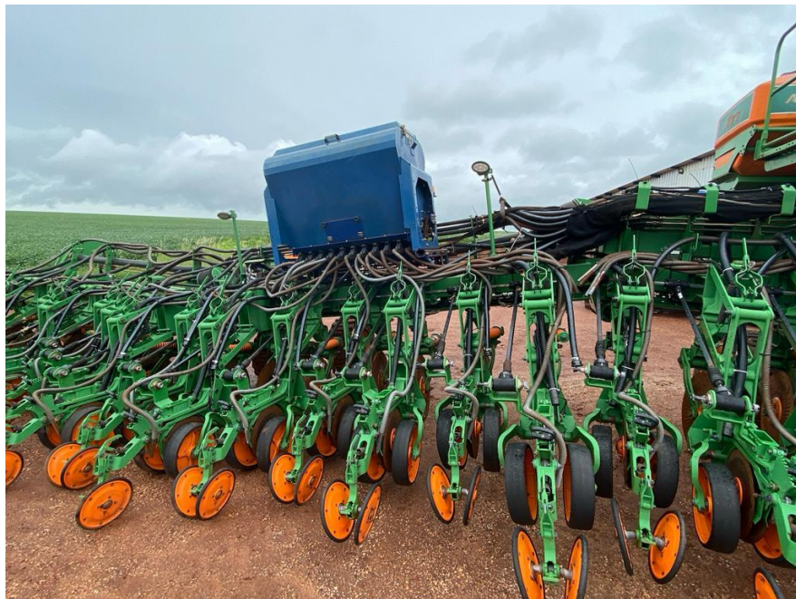
Figura 4: Máquina da Magno montada em uma plantadeira da Stara de 40 linhas na região de Acreúna – GO.
