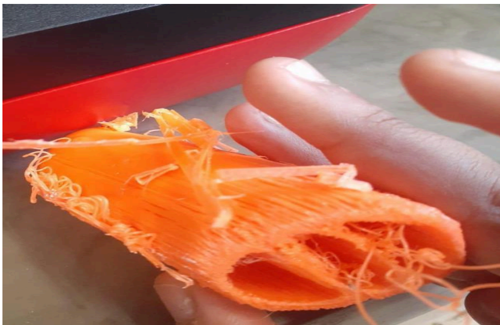
Figura 25: modelo 3D não aderido na mesa de impressão 3D
