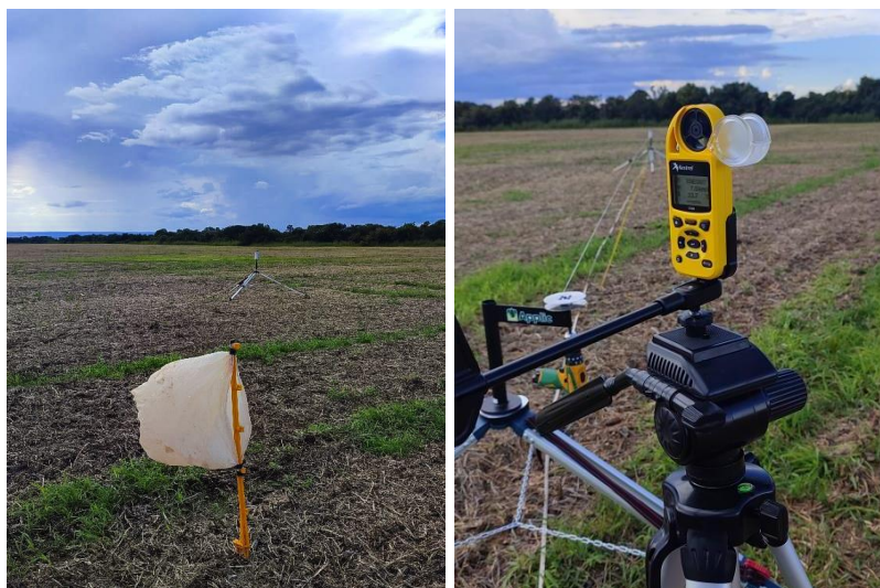
(A) Demarcação do centro da linha, (B) Termo-higro-anemômetro Kestrel®. Fonte: OLIVEIRA, 2023.
