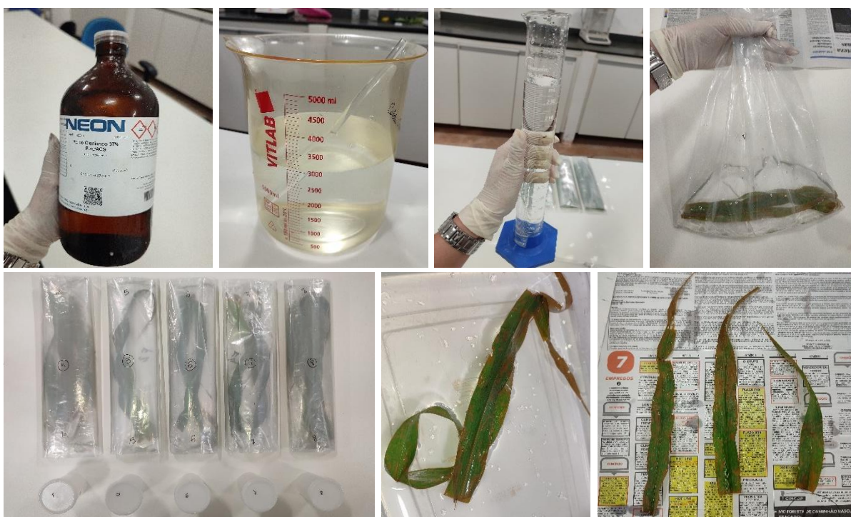
(A) ácido clorídrico (HCl), (B) calda ácida, (C) volume de diluição (250ml), (D) preparo das amostras, (E) repouso, (F) lavagem e (G) secagem das folhas. Fonte: OLIVEIRA, 2023.
