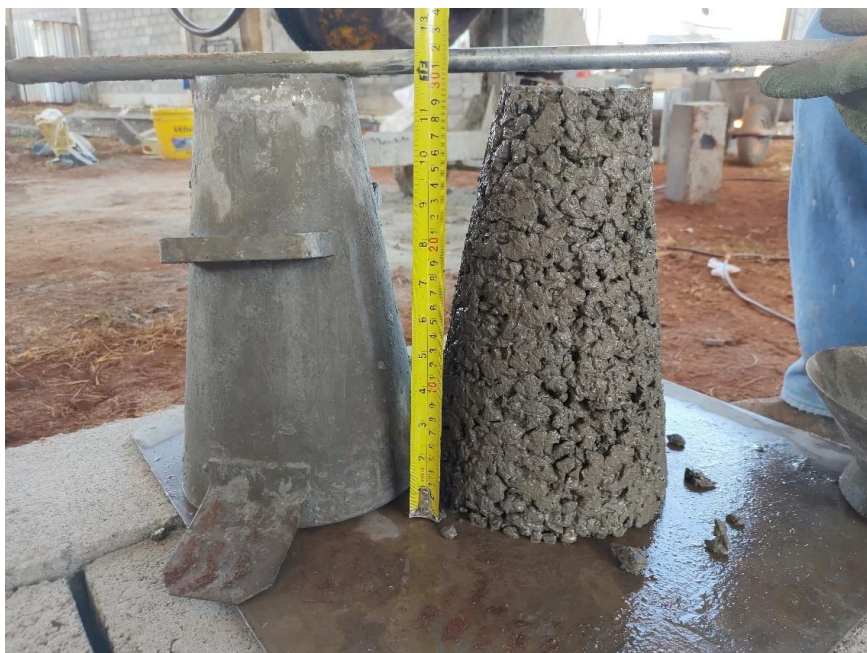
Figura 09 – Slump Test Traço X.
