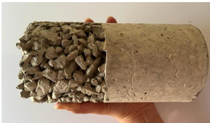
Figura 17 – Concreto em duas fases.
