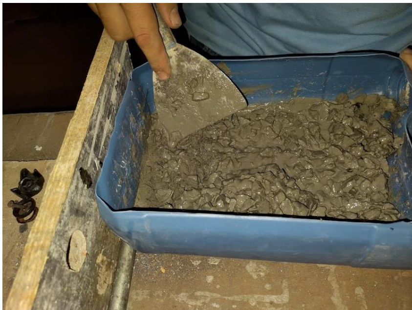
Figura 04 – Moldagem, teste manual, índice 0,3% aditivo.
