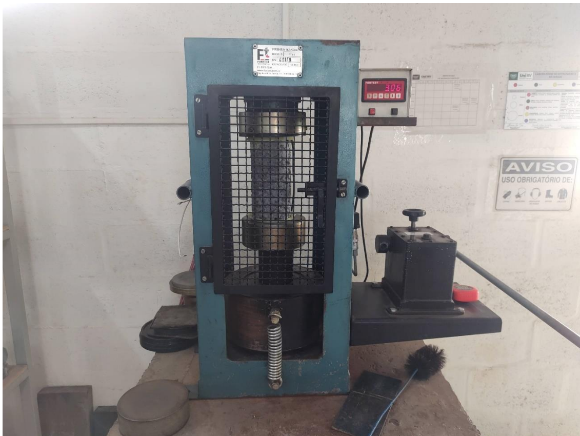
Figura 11 – Prensa Hidráulica Manual, Modelo FT02.
