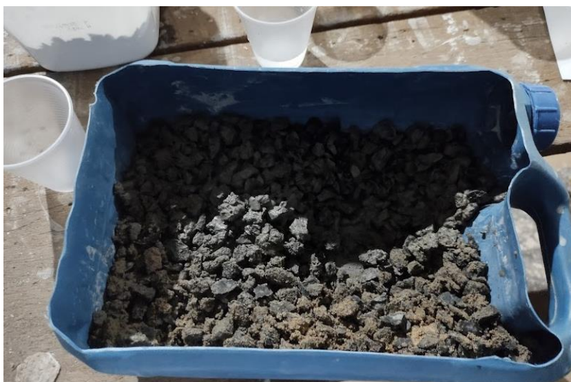
Figura 05 – Moldagem, teste manual, índice 0,1 % aditivo.
