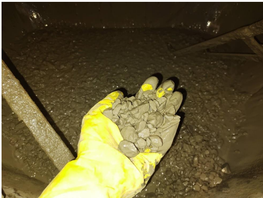
Figura 15 – Concreto em estado fresco após adição de 0,003 de aditivo em cima da massa de cimento.
