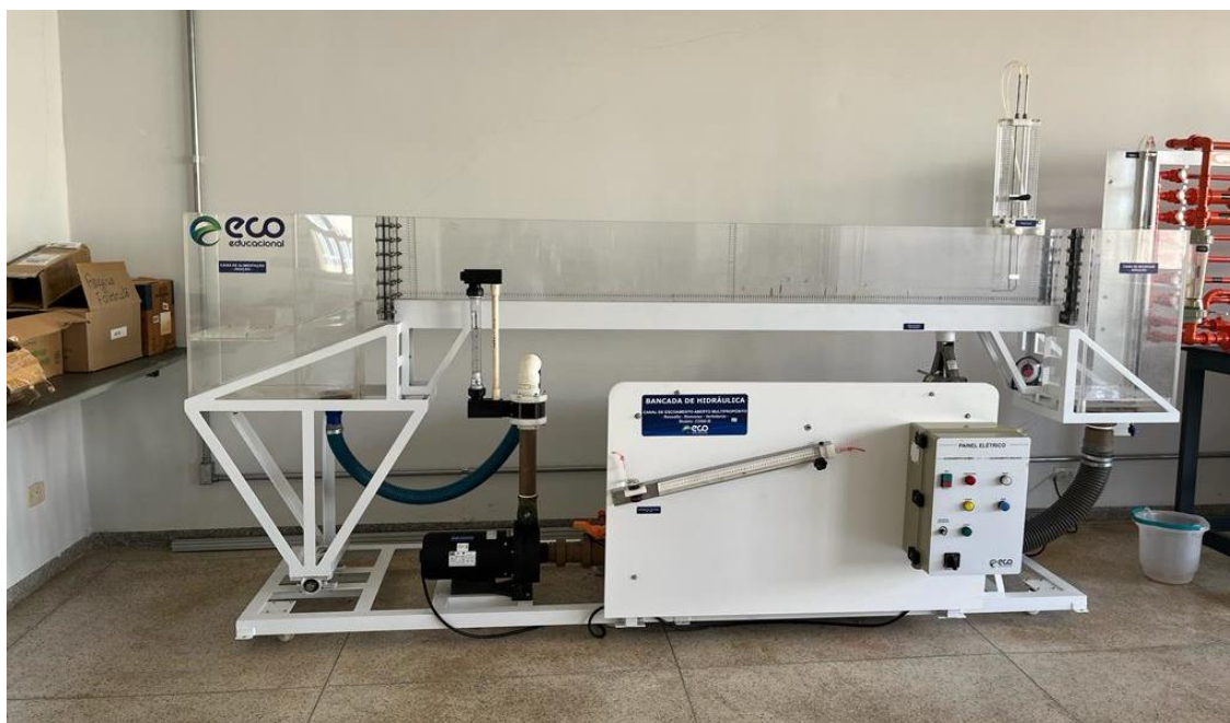
Figura 13 – Mesa hidráulica com tubo de Pitot.
