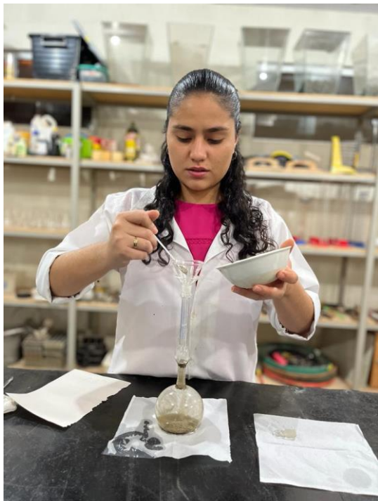
Figura 03 – Massa específica cimento, frasco Le Chatelier
