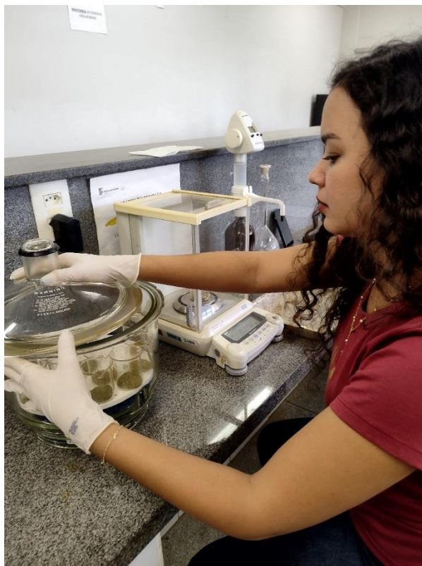
Figura 17 - Determinação de umidade gravimétrica a 105 °C de forragem para cálculo da matéria seca definitiva
