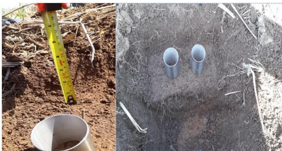
Figura 7 - Coleta de amostras indeformadas para determinação da curva de retenção de água no solo Fonte: Arquivo pessoal (2021).
