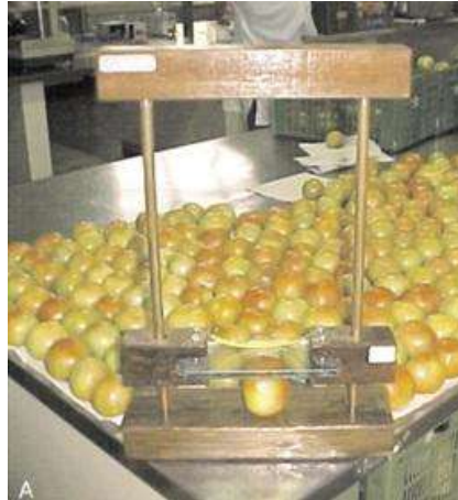
Figura 4. Aplanador usado para medição de firmeza dependente do turgor celular. Fonte: Moretti (2006).
