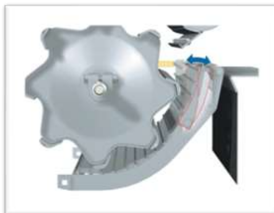
Figura 4: Exemplo de um cilindro de barras com exemplo de regulagem do côncavo. Fonte: Nunes (2016).
