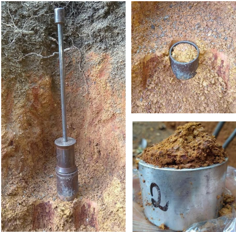
Figura 1. Amostrador de Uhlend para coleta de amostras em solos cascalhentos. Fotos: Eduardo da Costa Severiano
