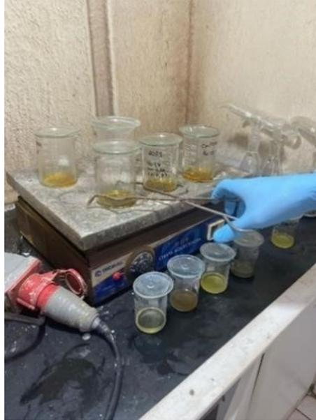
**Figura 7** - Análise de solubilidade do Sulfato de Manganês no laboratório da fábrica da empresa Araguaia, Anápolis – GO.
