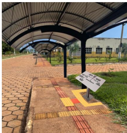
Figura 27: Simulação de mapa tátil, piso tátil e cobertura na área externa do IF-Goiano. Fonte: Autoria própria (2023).
