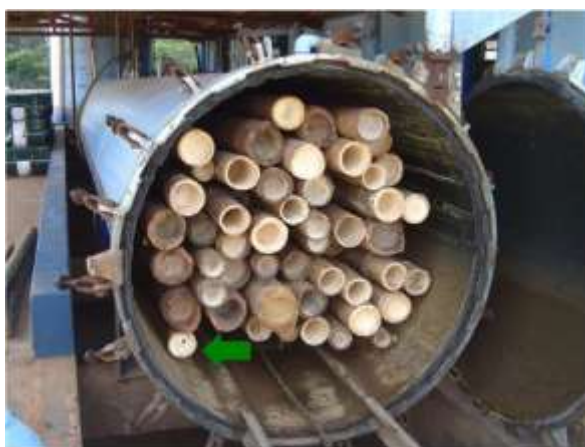
Figura 10. Tratamento de colmos de bambu em autoclave.
