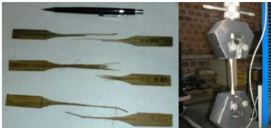
Figura 8. Corpo de prova de bambu utilizado nos ensaios de tração axial paralela às fibras e Prensa utilizada para a realização do ensaio.
