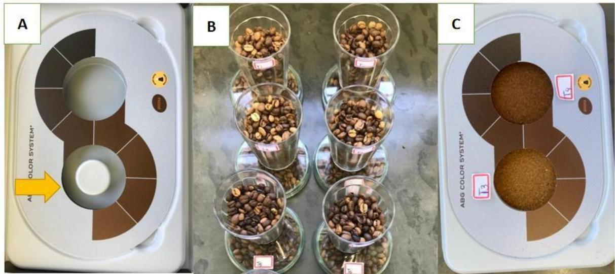
**Figura 7:** A: Tamper usado para compactação. B: amostras prontas para moagem. C: amostra torrada e moída para a avaliação da cor.
