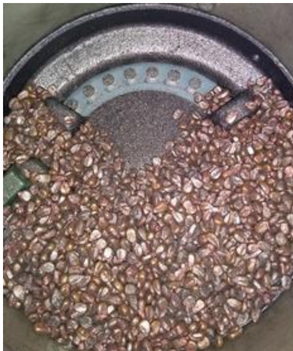
Figura 5. Sementes de milho tratadas e com grafite sendo testadas no mecanismo dosador.
