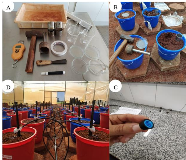
Figura 3 – Procedimentos na instalação do experimento. (A): ferramentas utilizadas na análise de capacidade de vaso; (B): coleta das amostras indeformadas do substrato para análise da capacidade de vaso; (C): gotejador autocompensante utilizado na irrigação do experimento; (D): sistema de irrigação via gotejamento já instalado nos vasos.
