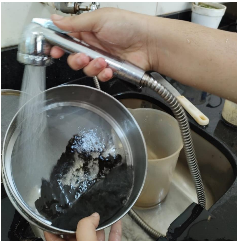
Figura 3. Lavagem de solo em peneira de 400 Mesh para coleta de nematoides.
