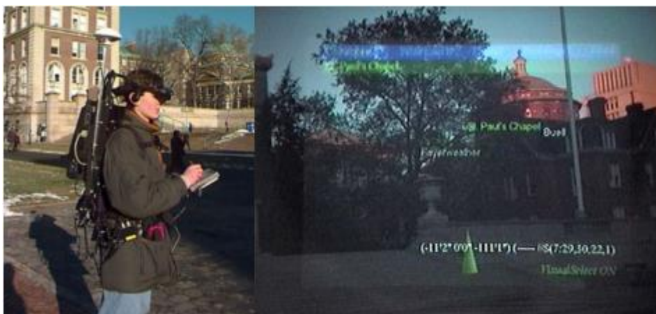
Figura 3: A esquerda: A mochila e o visor portátil sendo usados. À direita: uma visão através do visor do capacete
