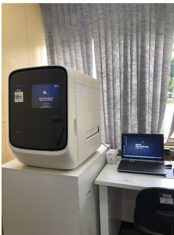
Figura 8: Aparelho de PCR em tempo real QuantStudio, utilizado para a realizar a genotipagem.
