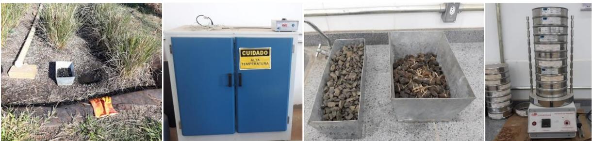
Figura 11 – Passo a passo segundo NBR 7217. Fonte: Acervo Pessoal.
