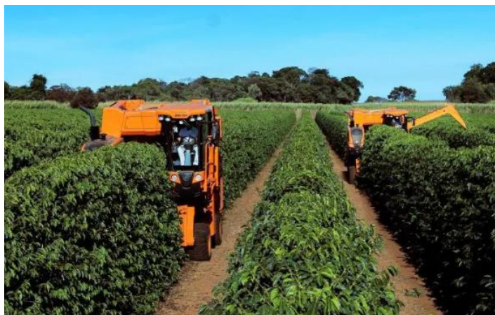
Figura 3: Colhedora K3, a primeira colhedora de café do mundo. Fonte: Jacto (2019).
