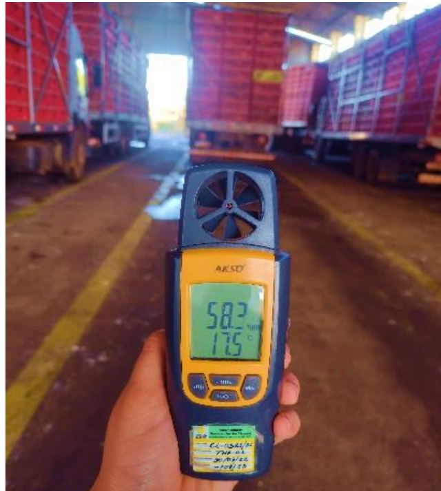
Figura 2 – Termo Higro-anemômetro digital para aferição de temperatura e umidade do galpão de espera, onde a umidade é descrita na parte superior e a temperatura é dada em graus Celsius na parte inferior da tela.
