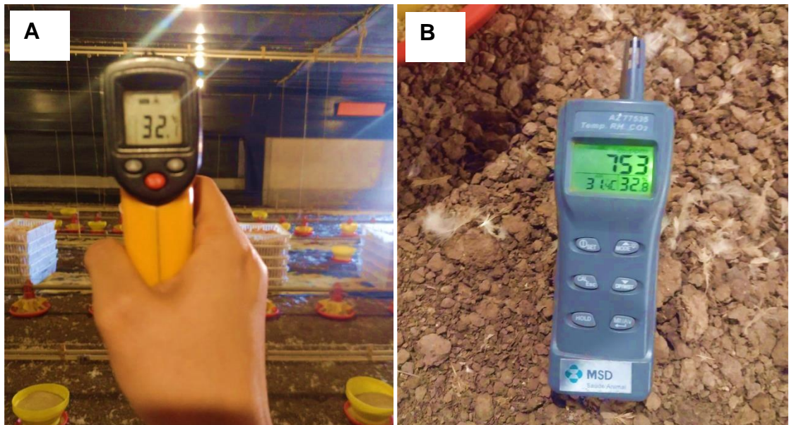
Figura 5A - Aferição de temperatura do galpão durante o alojamento com o auxílio de um termômetro medido em graus Celsius. Figura 5B – Aferição de CO 2 , temperatura e umidade da cama de aviário, dados em ppm, graus Celsius e percentual, respectivamente, durante o alojamento com o auxílio de um medidor de CO 2 , temperatura e umidade.
