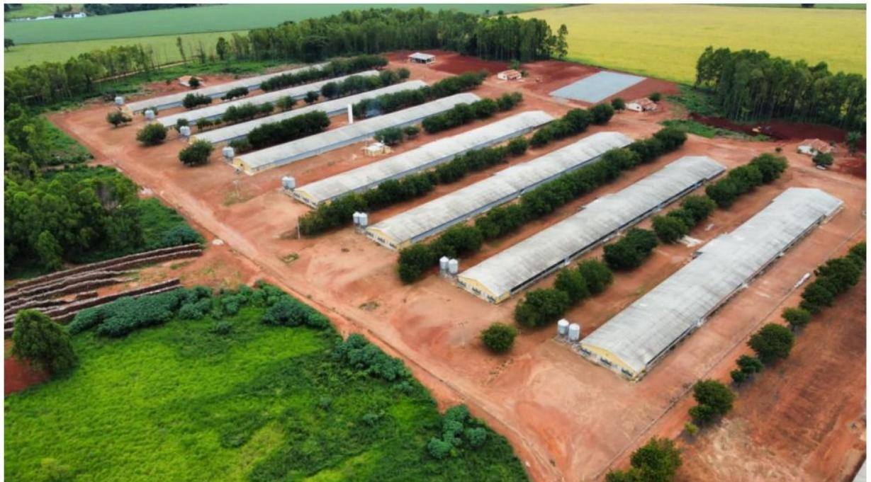
**Figura 1:** Núcleo de aviários localizado na região de Pires do Rio-Go, contendo oito aviários de pressão negativa cercado por alambrado, ao lado esquerdo presença de lenha empilhada preparada para ser utilizada no aquecimento da fase inicial das aves, a direita dos aviários as casas dos granjeiros e placas de captação de raios solares para geração de energia elétrica.
