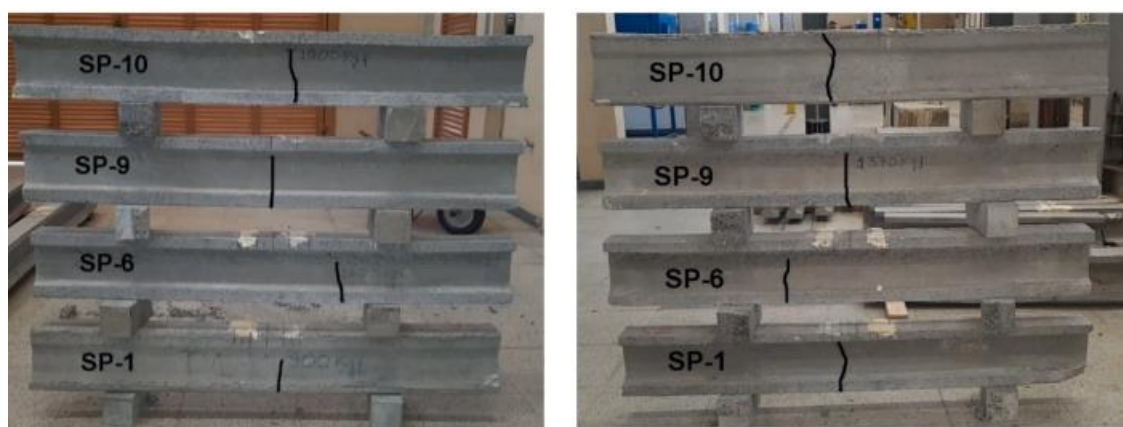
Figura 7: Fissuras por flexão.
