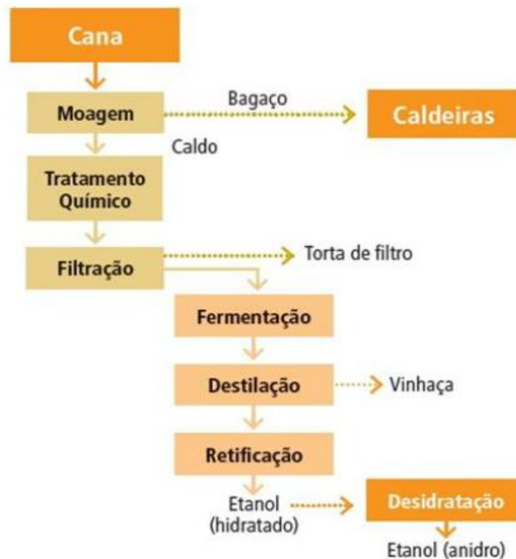
Figura 2. Fluxograma do processo de produção de Etanol
