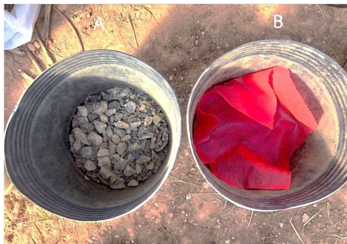
Figura 3 Sistema de drenagem utilizado no experimento sendo (A) camada com brita e (B) filtro de TNT.
