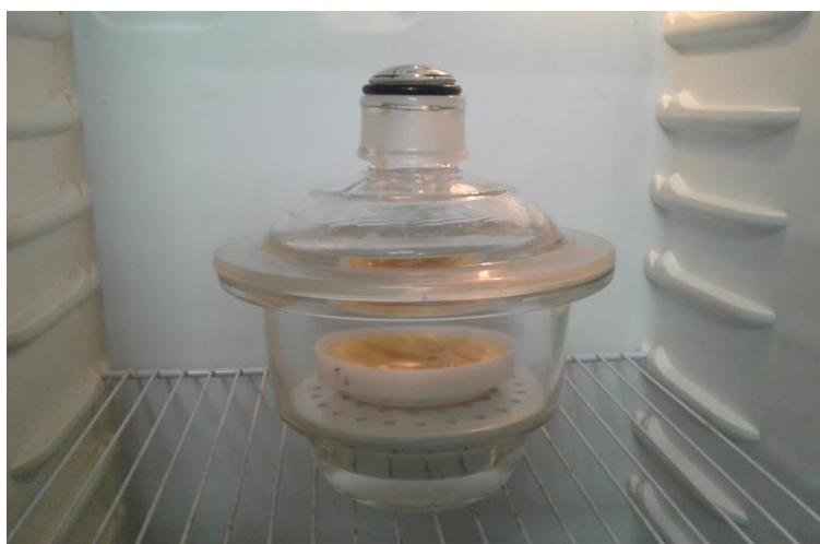
Figura 1. Cápsula e dessecador utilizados na determinação da PVA.
