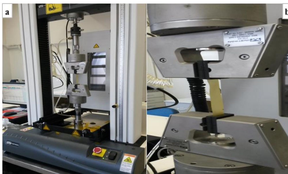
Figura 2. a e b testes de tração dos filmes em estudo.
