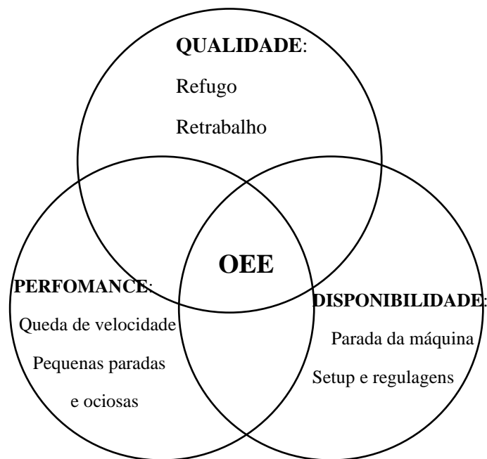
Figura 4: Elementos da avaliação de eficiência global de equipamentos. Fonte: Adaptado de Vieira, 2017.
