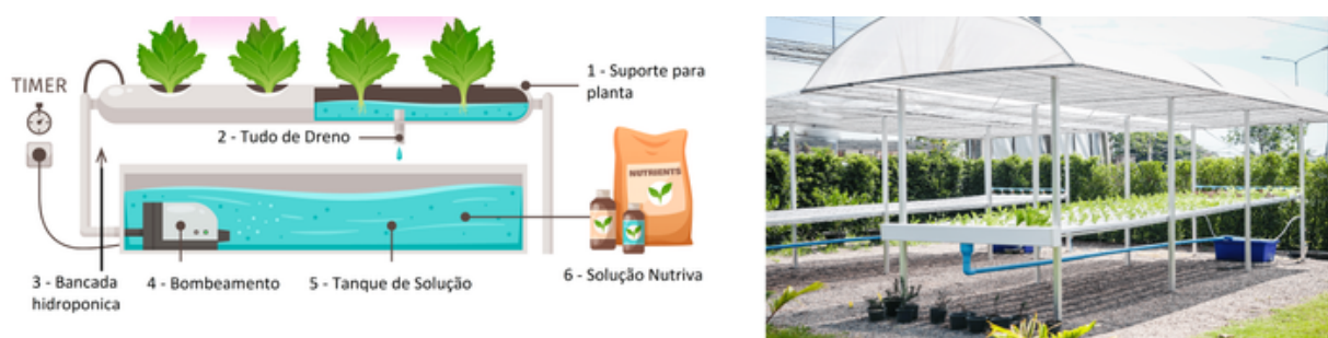
Figura 1 — Representação gráfica do sistema de produção NFT
