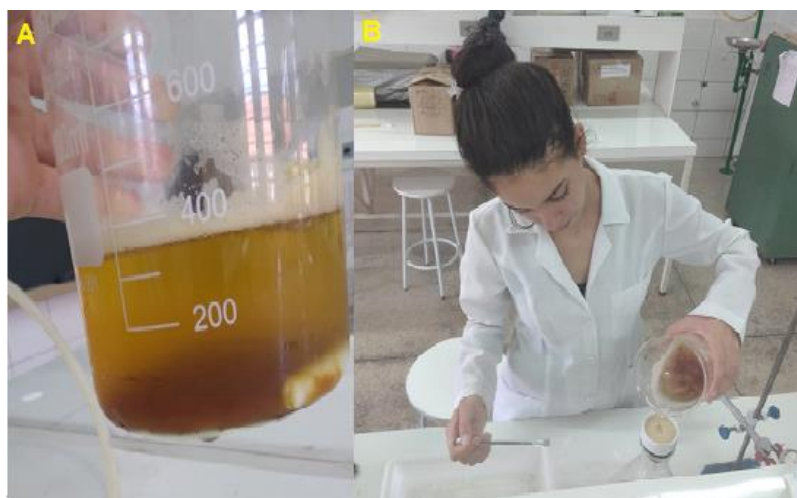
Figura 6. (A) Lapachol após a adição de \text{HCl} . (B) Filtração a vácuo do Lapachol precipitado.
