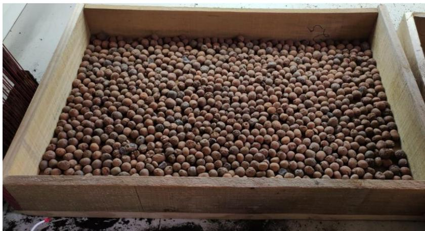
Figura 33 – Camada de argila expandida. (Elaborado pelo autor, 2022).
