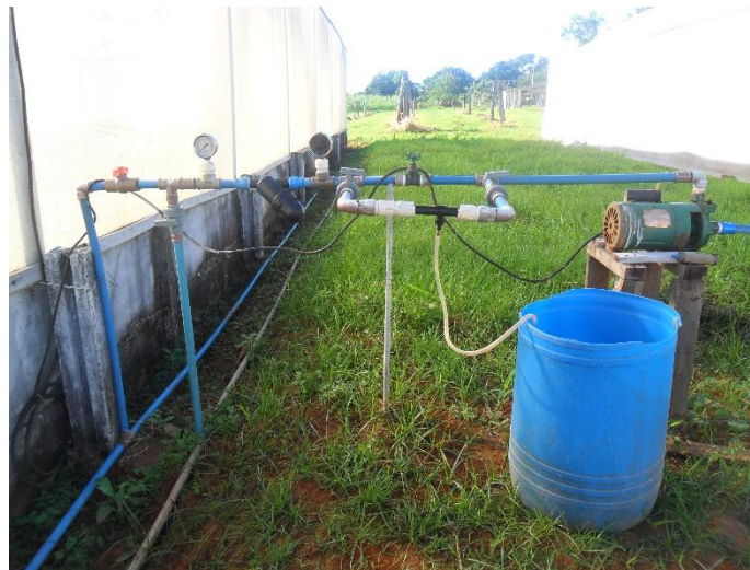
Figura 1. Sistema de bombeamento e injetor de fertilizante tipo Venturi. IF Goiano-Campus Urutaí-GO, 2019.
