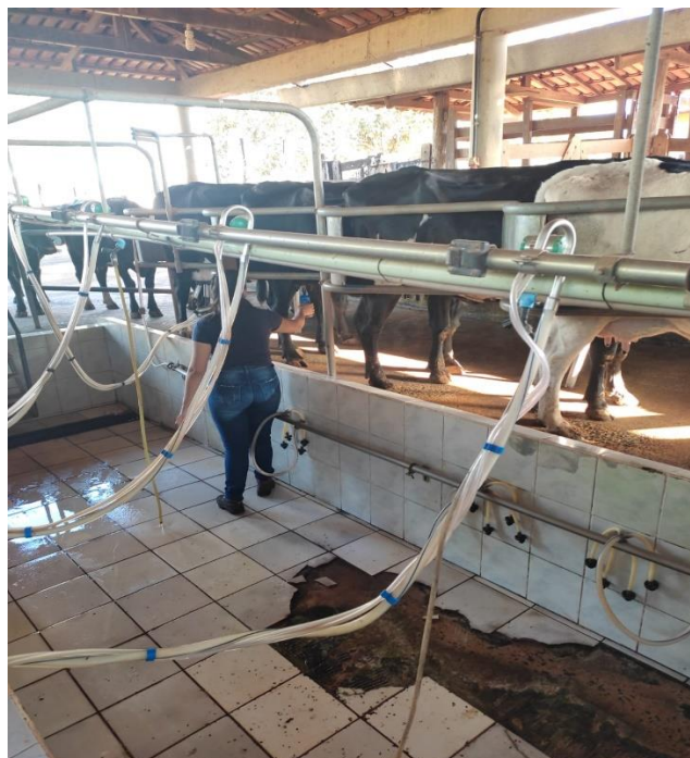
Figura 3 - Ordenha das vacas com a ordenhadeira tipo “espinha de peixe”.
