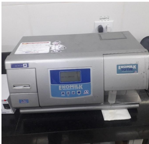
FIGURA 1: Ekomilk- analisador de proteínas, gordura e lactose- Fonte: fotografia do autor, Acesso em: 22/03/2021.
