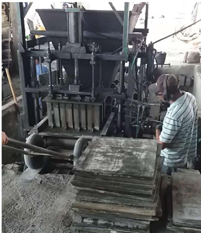
**Figura 11.** Máquina hidráulica utilizada na produção dos blocos de concreto.
