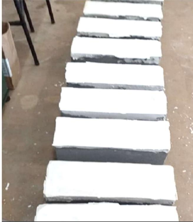
**Figura 22.** Corpos de prova com faces de trabalho regularizadas com pasta de gesso e com espessura de 3 mm.
