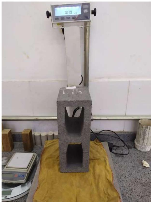
**Figura 21.** Pesagem do corpo de prova em condição saturado com superfície seca.
