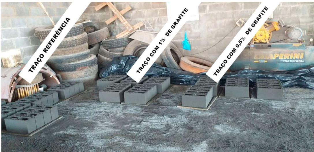
**Figura 17.** Produção dos corpos de prova
