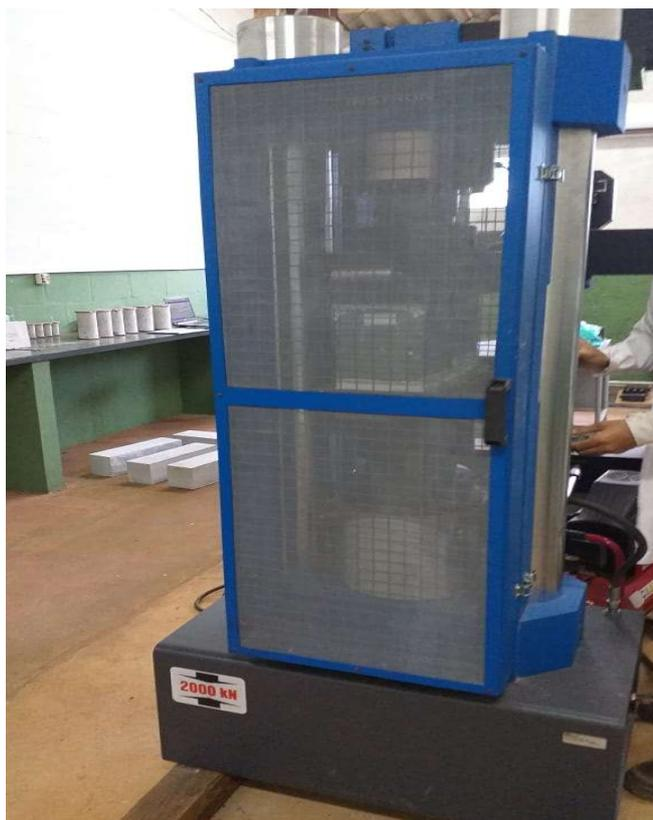
**Figura 23.** Ensaio de resistência a compressão.
