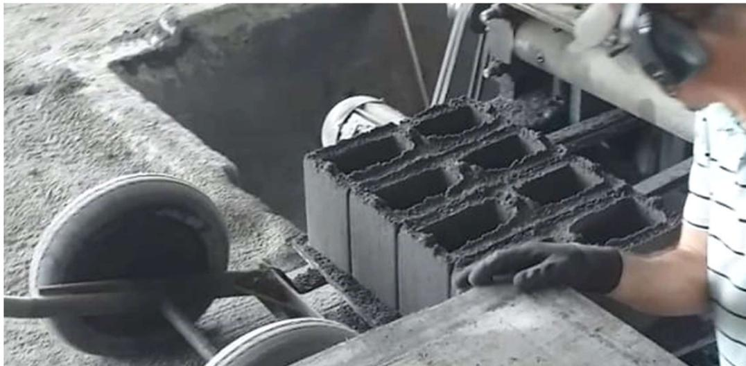
**Figura 16.** Produção dos corpos de prova
