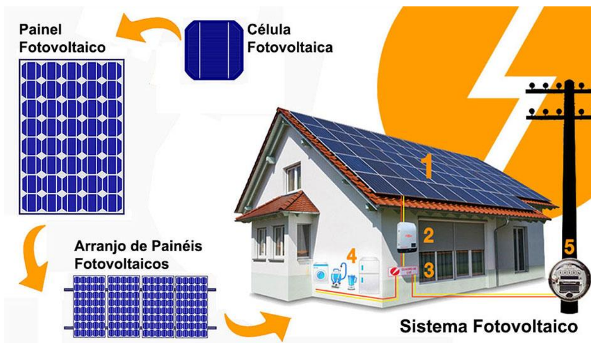
Figura 4. Arranjo de Painéis Fotovoltaicos. Fonte: PORTAL SOLAR, 2022.
