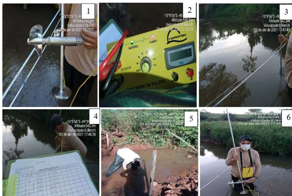
Figura 5.3 - Molinete hidrométrico de Newton (1), Contador de pulsos (2), Corda e trena (3), Planilha de dados (4) Estacas (5) Montagem para a medição da vazão (6).
