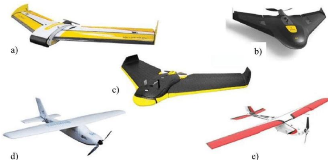
Figura 4 - Exemplos de alguns drones comerciais de asa fixa: a) QuestUAV; b) SenseFly eBee; c) Trimble UX5; d) MAVinci Sirius Pro; e) PrecisionHawk Lancaster. (PÁDUA et al., 2017).
