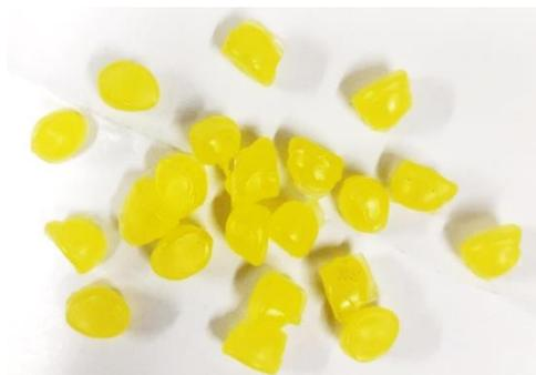
**Figura 9:** porções equivalentes ao volume de PVC por rolha.
