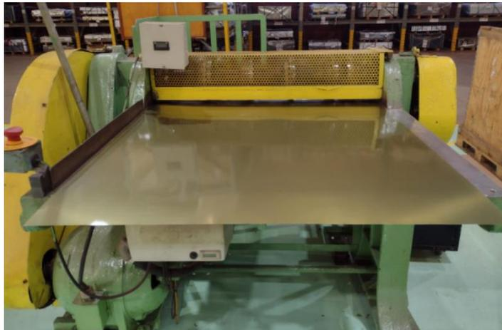
**Figura10: Tesoura para corte que transforma folhas de flandres em tiras para fundo 099. As partes em amarelo são proteções para as partes móveis que podem causar acidentes.**
