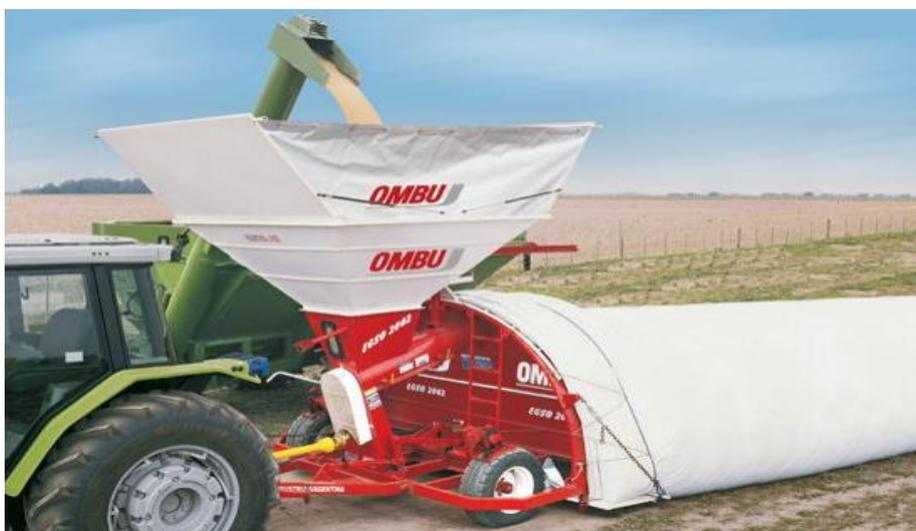
**Figura 2.** Máquina embutidora de silos bolsa. Fonte: Jorge Máquinas, 2014.
