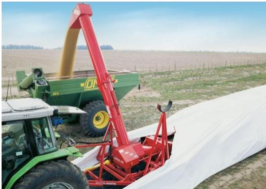
**Figura 3.** Máquina extratora de silos bolsa. Fonte: Jorge Máquinas, 2014.
