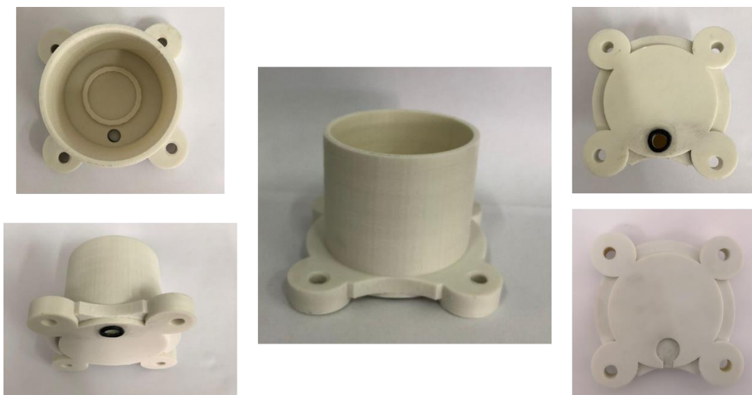
Figura 11. Todos os componentes da célula eletroquímica BIA impressos.
