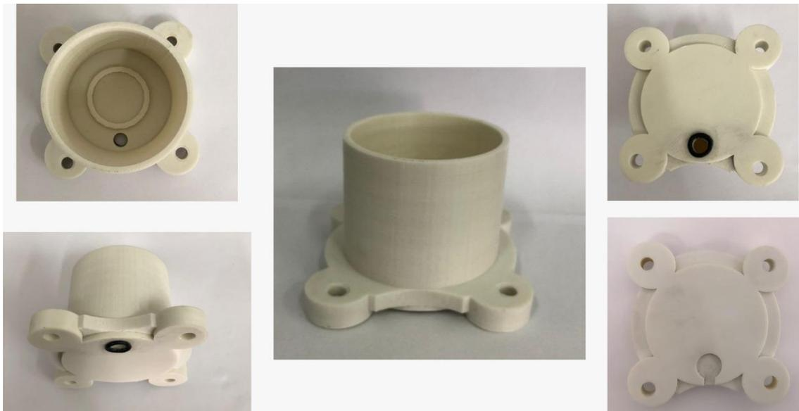
**Figura 3.** Célula eletroquímica impressa na impressora GTMaX 3D com filamento ABS não condutivo.
