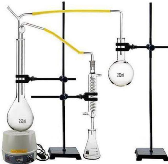
Figura 3: Aparelho Destilador Likens-Nickerson
