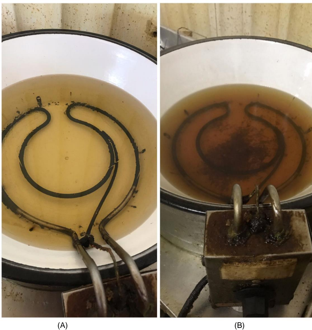
Figura 4: Óleo coletado no início (A) e após 6 horas de fritura contínua (B).
