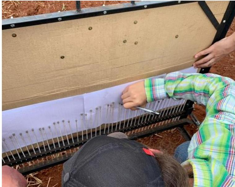
**Figura 5.** Aquisição de dados de mobilização do solo no perfilômetro.
