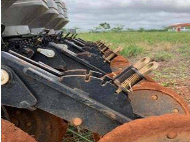
**Figura 4.** Regulagem do sistema de fechamento de sulco.
